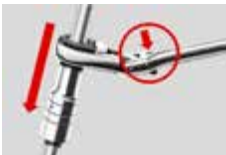
Con agujero pasante para pernos y varillas roscadas. Mecanismo de trinquete flexible Cabeza con cerradura.
